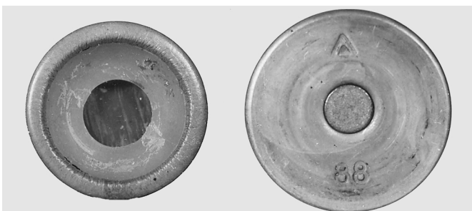
Рис. 14, 15, 16. Изображения внешнего вида 23-мм специального патрона с дистанционной гранатой «Черемуха-7» (на рис. 15 этот патрон показан со стороны дульца гильзы, а на рис. 16 – со стороны дна основания гильзы)
