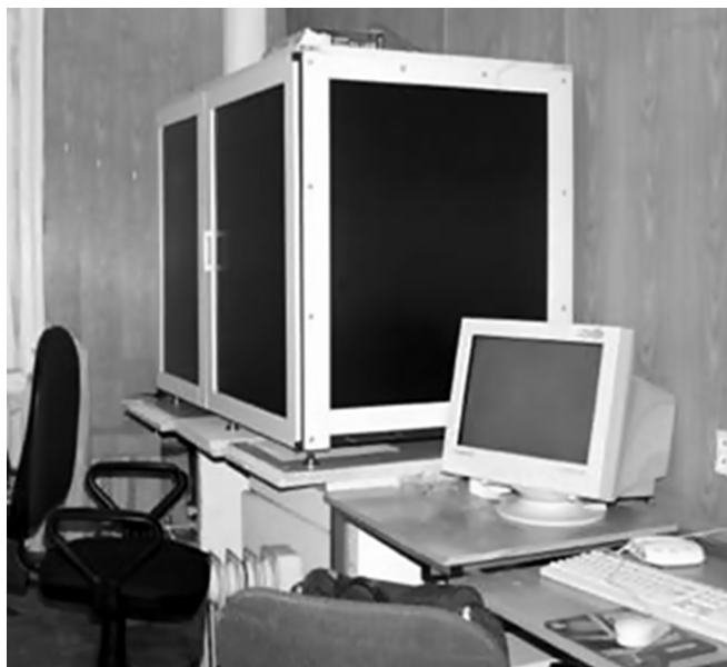
Рис. 2. Прибор для трехмерного моделирования черепа при краниофациальной идентификации методом компьютерного фотосовмещения, входящих в состав аппаратно-программного комплекса «3D-TADD»
