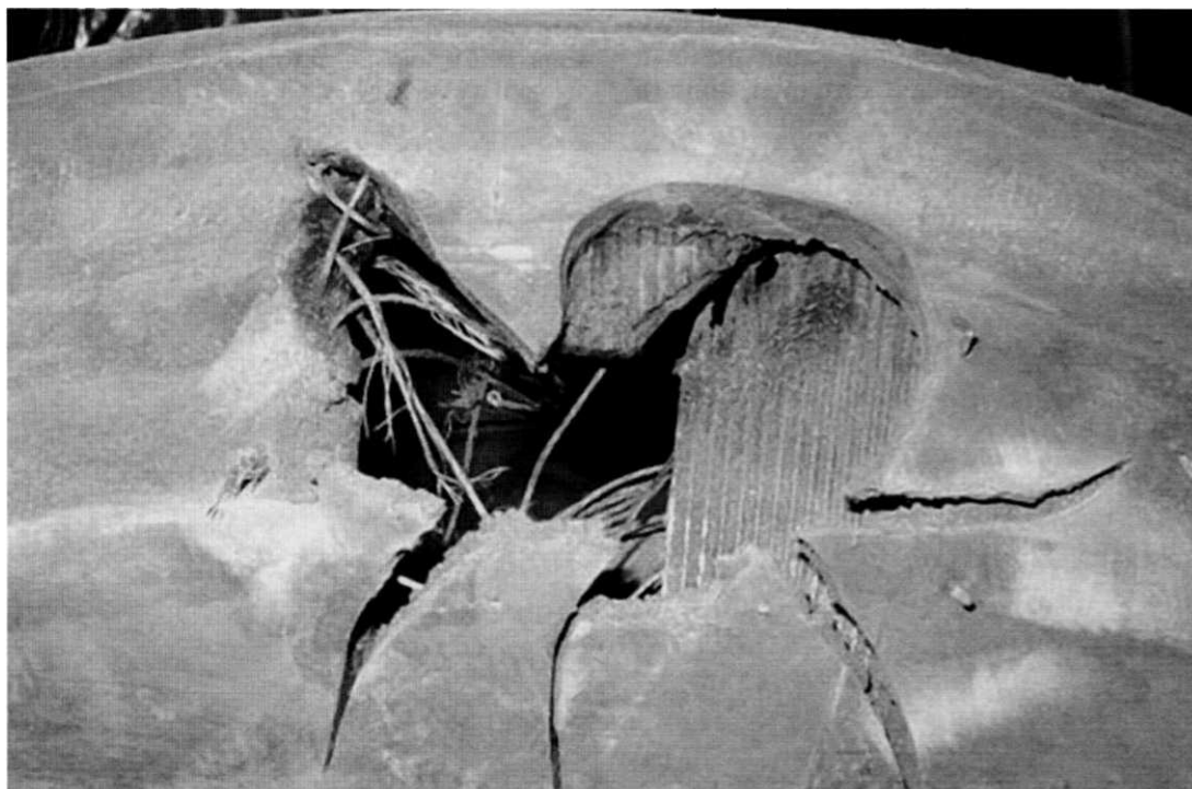
Рис. 23. Разрушение по типу «пневматический взрыв» бескамерной шины
