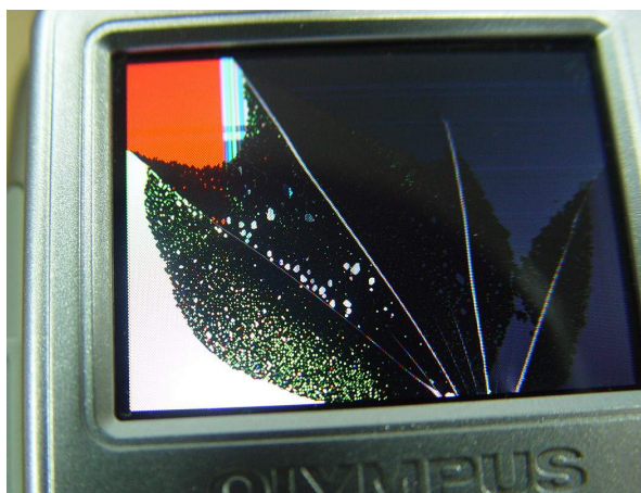
Рис.3. Внешний вид системы трещин в ЖК дисплее.
