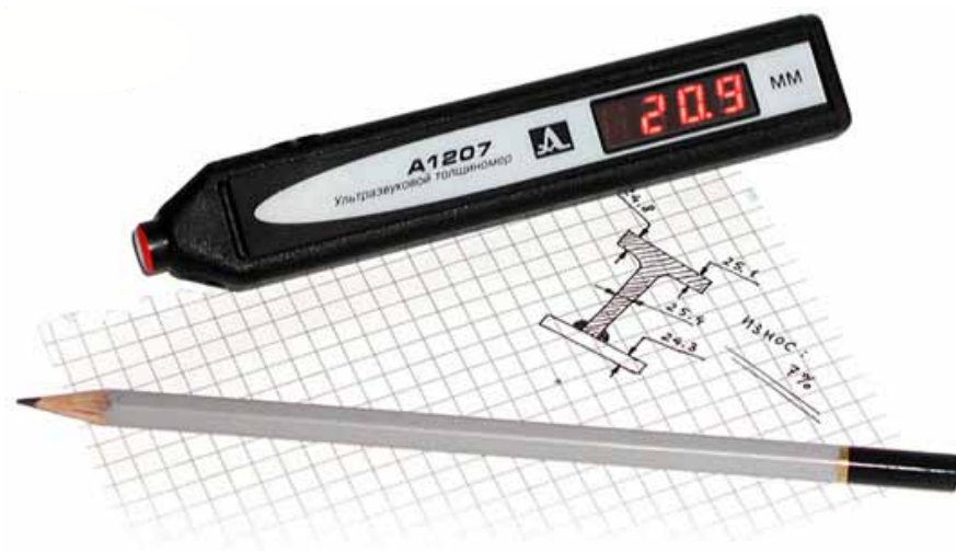
Рис. 1. Ультразвуковой толщиномер А1207
