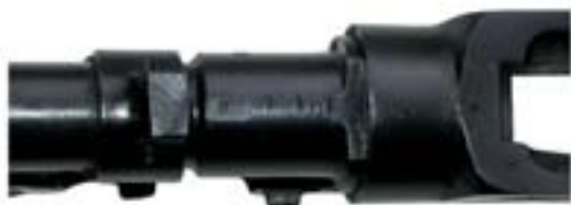
Фото 13. Номер партии металла, плавки из которого изготовлен ствол карабина.
