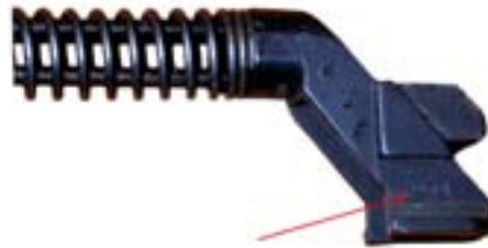
Фото 34. Клеймо, нанесенное на задний выступ направляющего стержня возвратного механизма автомата при переводе его в категорию учебного оружия.
