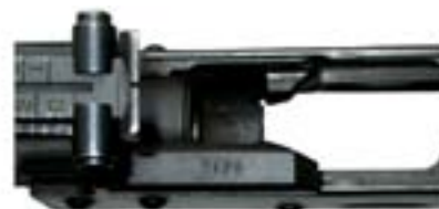
Фото 20. Три последние цифры заводского номера оружия, нанесенные на задний выступ направляющего стержня возвратного механизма автомата АКМ.
