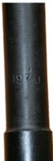
Фото 21. Номер партии металла, плавки из которого изготовлен ствол автомата: А - автомата АК, Б - автомата АКМ.
