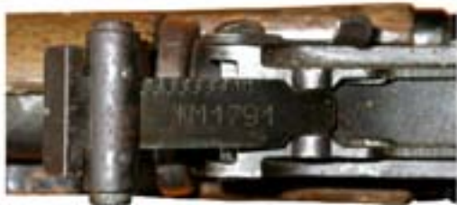
Фото 24. Заводской номер оружия, нанесенный в армейских мастерских на оборотную сторону прицельной планки автомата АК.
