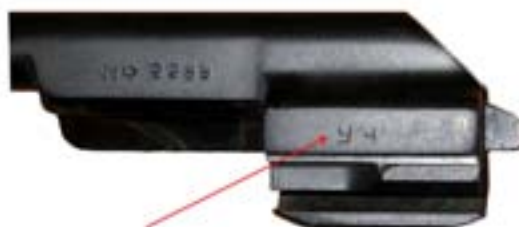
Фото 31. Клеймо, нанесенное на затворную раму автомата при переводе его в категорию учебного оружия.
