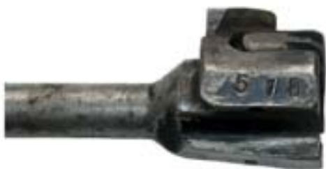
Фото 9. Три последние цифры заводского номера оружия, нанесенные на затвор автомата АКС-74У.
