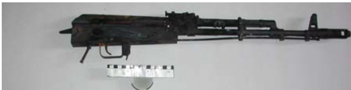
Фото 2. Обгоревший 5,45-мм автомат Калашникова (АК-74) №Б, представленный на экспертизу.
