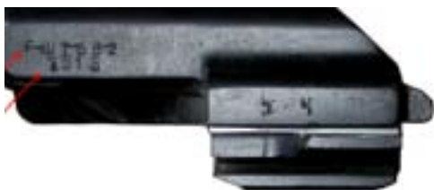
Фото 28. Серийный номер оружия на затворной раме автомата АКМ: А - нанесенный после ремонта на военном заводе; Б - первоначальный серийный номер оружия.
