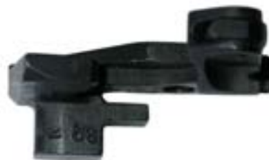
Фото 18. Три последние цифры заводского номера оружия, нанесенные на замедлитель курка автомата АКМ.
