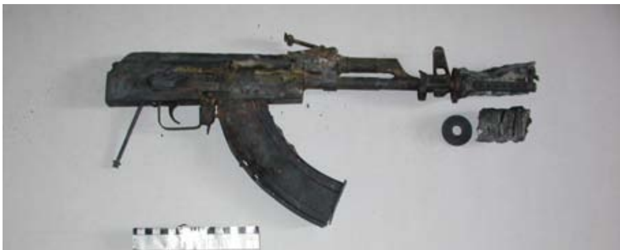
Фото 1. Обгоревший автомат №А, собранный самодельным способом, из различных частей автоматов Калашникова, представленный на экспертизу.
