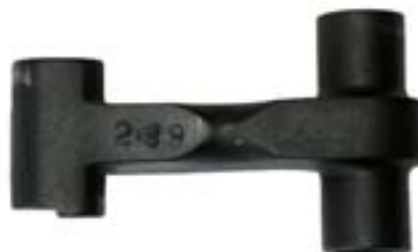
Фото 15. Три последние цифры заводского номера оружия, нанесенные на курок автомата АКМ.
