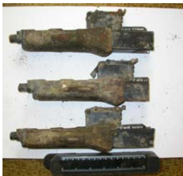
Фото 6. Общий вид фрагментов стволов с патронником, цевьем и фрагментом ствольной коробки, представленных на экспертизу, с помощью которых получены первичные следы.
