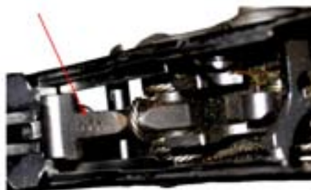
Фото 16. Три последние цифры заводского номера оружия, нанесенные на курок автомата АКМ и видимые при его неполной разборке.
