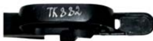
Фото 16. Заводской номер оружия, нанесенный на предохранительную скобу при ремонте карабина на военном заводе после удаления его первоначального номера.
