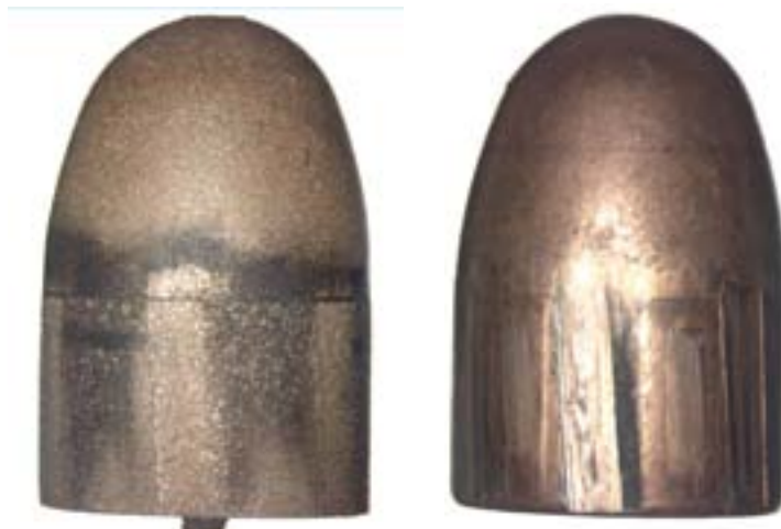
Фото 2. Общий вид пуль, выстреленных из 11,43 мм пистолета Кольт М1911. Слева – безоболочечная пуля из композиционного материала, справа –обыкновенная оболочечная пуля.
