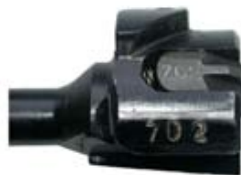
Фото 8. Три последние цифры заводского номера оружия, нанесенные на затвор и выбрасыватель автомата АК-74.
