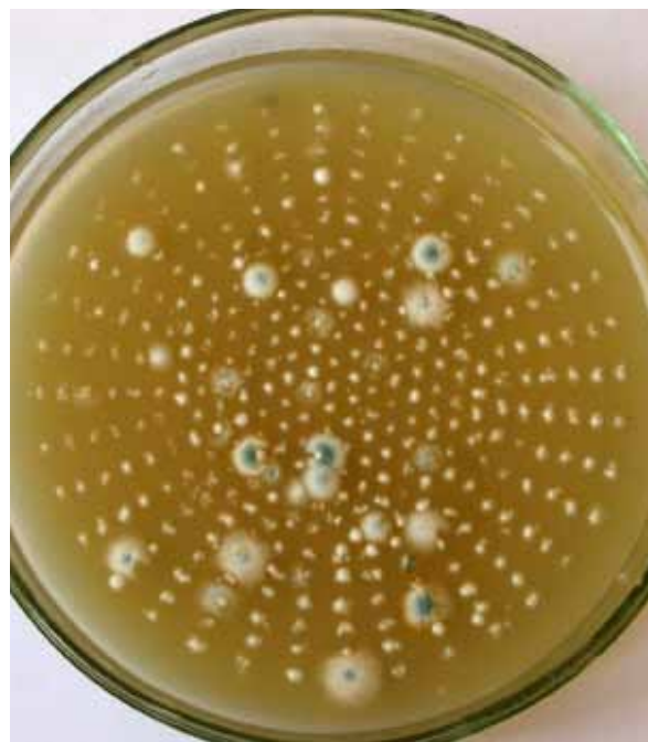
Рис. 1. Определение содержания грибов в воздухе помещений аспирационно-седиментационным методом
