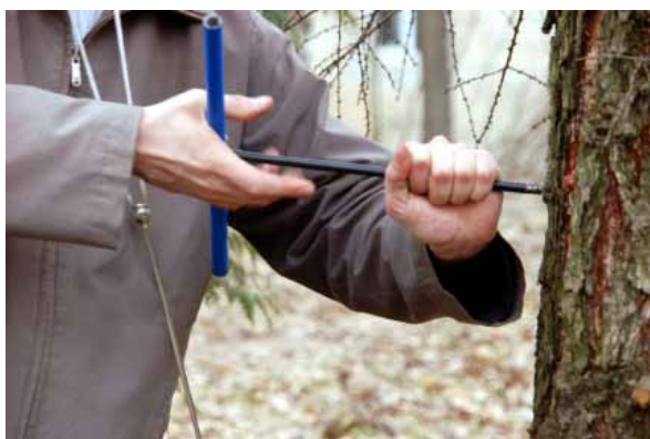
Рис. 6. Отбор образца древесины с помощью бура Пресслера
