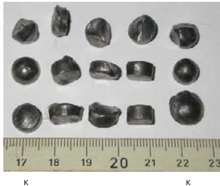
Фото 1. Общий вида картечи 8 мм, выстреленной из оружия .410 калибра («Сайга-410»): 1, 2, 3 – картечь в патроне 1, 2, 3; К – ряды крайних картечин.
