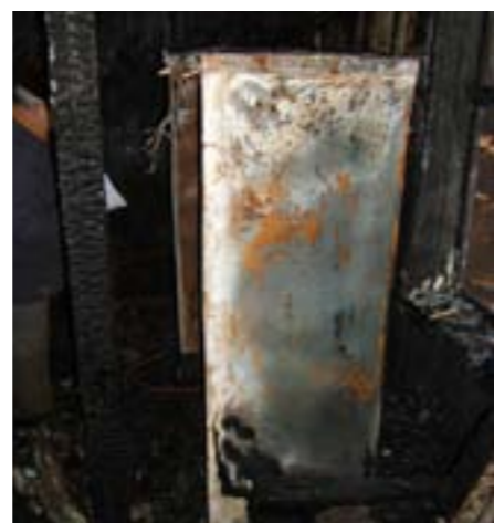
Фото 11. Вид пространства между стеной с окнами и задней стенкой морозильника (1). Кресло (2), находящееся справа от морозильника, расположено в 10 – 15 см от межоконного простенка. Вдоль задней стенки свисает провод без изоляции с утолщением (3), похожим на оплавление
