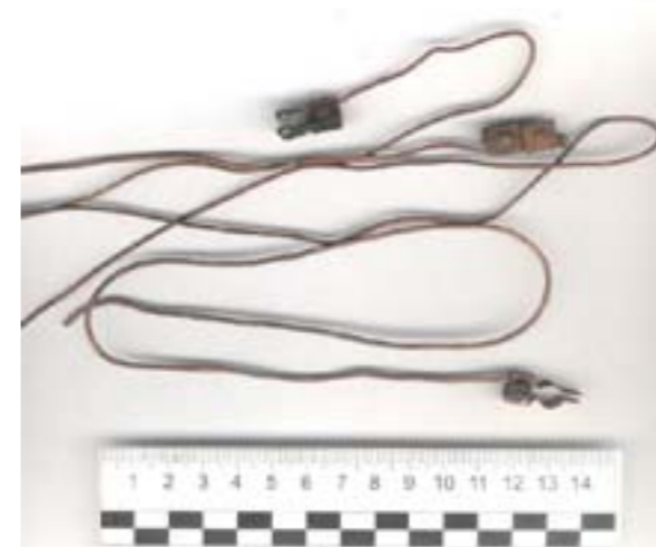
Фото 22. Вид извлеченных из пакета фрагментов медных однопроволочных жил диаметрами 1,4 мм (1,5 мм 2 ) (1) и 1,8 мм (2,5 мм 2 ) (2), подсоединенных к розеточным контактам (3, 4), отличающимся по конструкции
