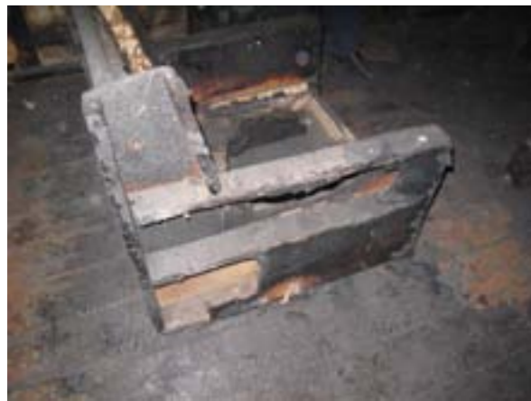
Фото 16. Вид с левой стороны кресла, выдвинутого на очищенный от пожарного мусора участок пола. Наружная тканевая обивка, обивка из ватина полностью выгорели. Обивка из оргалита (1) каркаса левой боковины кресла выгорела так, что граница зоны прогара (2) напоминает сторону очагового конуса с вершиной у задней стенки, т.е. у межоконного простенка, где кресло находилось во время пожара
