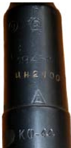
Фото 2. Заводской номер оружия нанесённый на заднюю часть ствола карабина образца 1944 года (над патронником).
