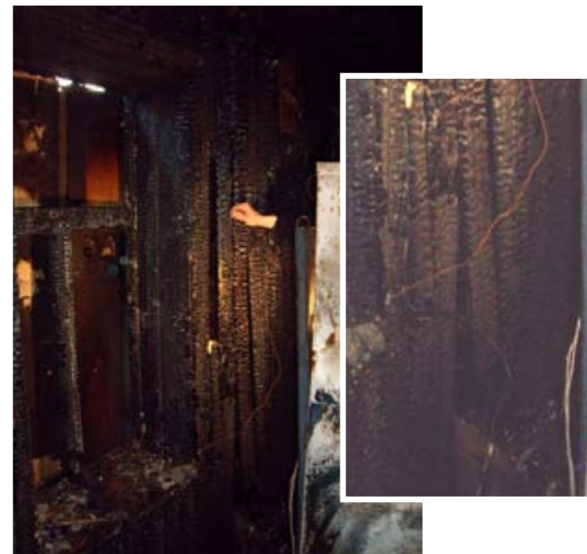
Фото 28. Вид пространства между морозильником и стеной с двумя окнами. Проложенный вдоль стены двухжильный провод (1) с медными многопроволочными жилами в нижней части межоконного простенка проходит рядом с неизвестным (неописанным в протоколе осмотра) предметом (2)
