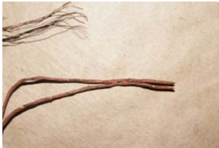
Фото 29. Участок двух свитых вместе проводников, сплавленных в двух местах (1), с каплями меди (2), застывшими на поверхности одной из жил, и характерными следами воздействия режущего инструмента на концах (3)
