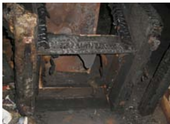
Фото 19. Вид снизу опрокинутого вперед кресла. Доски каркаса задней стенки (1) и стойка каркаса (2) левой боковины обуглились в нижней части кресла (рядом с полом) с поверхности, обращенной в сторону межоконного простенка. В большей степени и с заметно большей потерей сечения в нижней части обуглилась нижняя часть наклонной деревянной стойки (3), примыкающей к левой боковине кресла (4)
