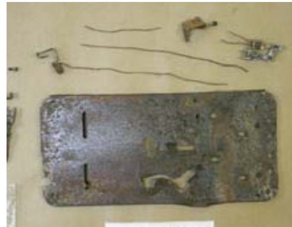
Фото 25. Вещественные доказательства, извлеченные из конверта: 1 – стальная пластина толщиной 0,7 мм для установки электросчетчика с S-образным сквозным проплавлением (2) и проплавлением на краю пластины (3) образовавшимся в результате КЗ; 4 – фрагмент однопроволочного медного проводника диаметром 1,4 мм (1,5 мм 2 ) со следами механического воздействия на одном из концов; 5 – латунный контакт автоматического выключателя с множественными микроплавлениями на контактной пластине; 6 – два латунных контакта электросчетчика с латунной перемычкой и двумя фрагментами однопроволочных проводников; 7 – два латунных контакта электросчетчика, соединенные медной S-образной перемычкой со следами электроэрозии на поверхности одного из них (8); один из прижимных винтов (9) оплавлен и короче другого винта на 30%
