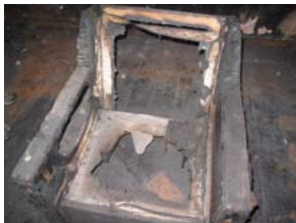
Фото 17. Вид спереди и сверху поврежденного пожаром кресла, находящегося на очищенном от пожарного мусора участке пола. Основания из оргалита спинки и сиденья выгорели. Судя по сохранившимся на сиденье и задней стенке фрагментам обивки с краями, завернутыми в сторону прогара, выгорание задней стенки происходило в направлении от простенка, напротив которого стояло кресло, сиденья – в направлении снизу вверх.
