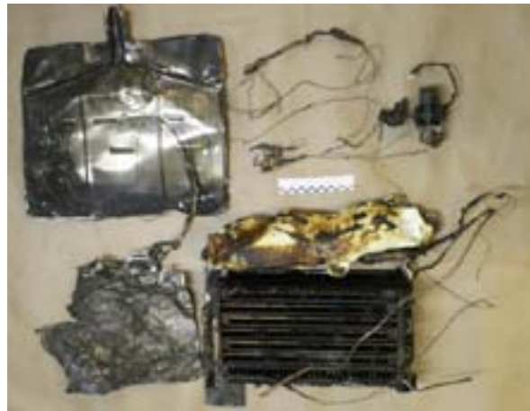
Фото 24. Поврежденные пожаром элементы системы НО ФРОСТ морозильника: 1 – испаритель (со стороны, обращенной в сторону дна холодильного прибора) с прилегающим к нему фрагментом внутренней пластиковой стенки шкафа и слоем ППУ (2); 3 – полка испарителя для сбора капель (поддон каплепадения); 4 – пластина нагревателя поддона каплепадения; 5 – фрагмент нагревателя поддона каплепадения; 6 – электродвигатель вентилятора с сохранившимся пластиковым корпусом и фрагментом оплавленной и обгоревшей крыльчатки (7) на оси. Изоляция на некоторых участках проводов полностью не выгорела
