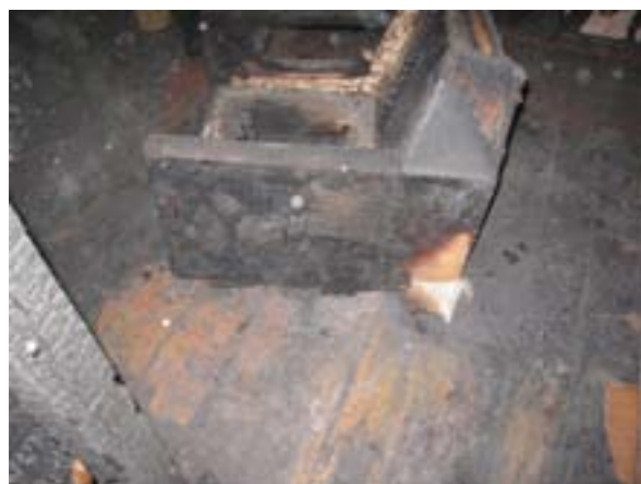
Фото 18. Вид с правой стороны поврежденного пожаром кресла, находящегося на очищенном от пожарного мусора участке пола. Обивка каркаса, выполненная из оргалита, выгорела только сверху боковины, причем граница (1) прогара имеет уклон в сторону спинки (простенка). В месте, к которому был прислонен мешок с картошкой, неповрежденным оказались и оргалит (2), и слой ватина (3)
