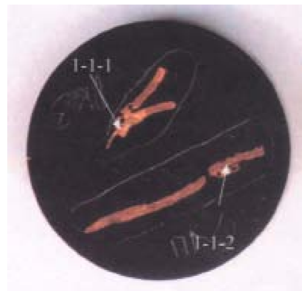
Фото 30. Общий вид шлифа 1 с образцами оплавленных медных проводников 1-1-1 и 1-1-2. Белыми стрелками указаны места оплавлений образцов медных проводников
