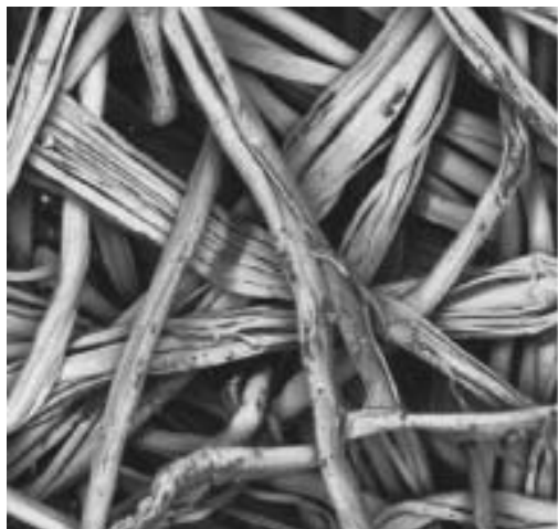
Фото 21. Вид пылевого фильтра при увеличении 500x, поле зрения 400 мкм)
