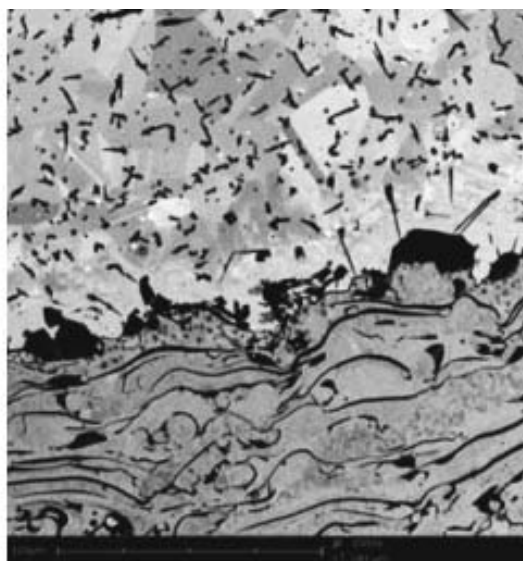
Фото 28. Поперечное сечение образца стали с плазменным покрытием. Можно оценить толщину покрытия, размер и распределение пор, оксидов, трещин, адгезию, загрязнения, наличие нерасплавленных частиц
