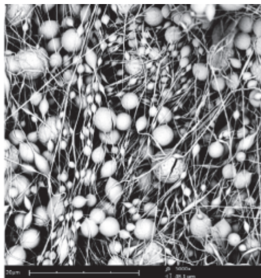
Фото 17. Нановолокно поливинилового спирта со сферическими включениями, 5000х
