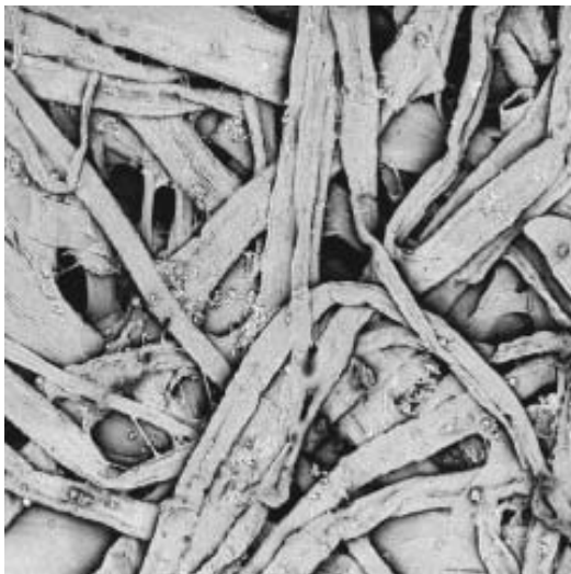
Фото 12. Изображение структуры обычной бумаги для печати. Видны отдельные волокна. Увеличение 830х, поле зрения 240 мкм
