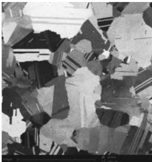
Фото 26. С помощью детектора обратно-рассеянных электронов можно различать материалы по интерференционной окраске. Это позволяет получать информацию об условиях, в которых было осуществлено воздействие на данный материал
