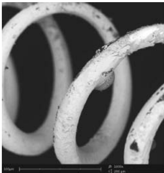
Фото 25. Нить лампы накаливания с осколками стекла. При столкновении автомобиля, если его фары были включены, вольфрамовая нить раскалена и осколки расплавленного стекла будут на поверхности вольфрамовой нити
