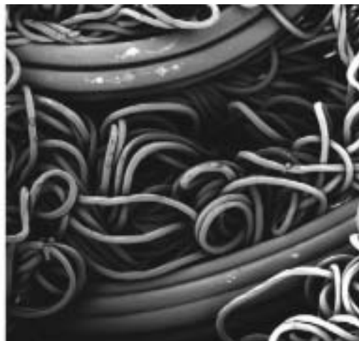
Фото 22. Включения эластичных волокон в нейлоне
