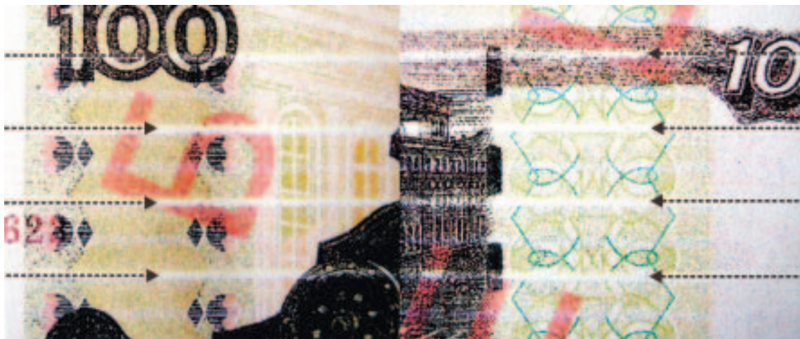
Рис. 4а. Совмещение пробельных полос, образовавшихся от неисправных форсунок (образцы денежных билетов 100 рублей Банка России выполнены при одинаковых режимах печати, напечатаны при использовании одного картриджа; изображения выводились на печать в режиме: черновая)
