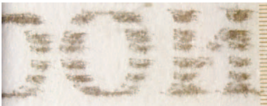
Рис. 3. Измерение с помощью линейки окуляр-микрометра
