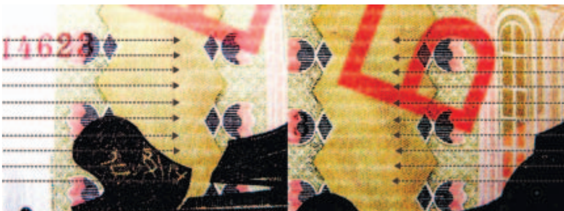
Рис. 4б. Совмещение пробельных полос, образовавшихся от неисправных форсунок (образцы денежных билетов 100 рублей Банка России выполнены при одинаковых режимах печати; напечатаны при использовании одного картриджа; изображения выводились на печать в режиме: обычная)
