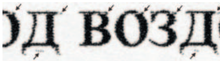
Рис. 8. Изображение фрагмента текста, отражающего признаки ошибок функционирования печатающего механизма (стрелками отмечены признаки функциональных сбоев)
