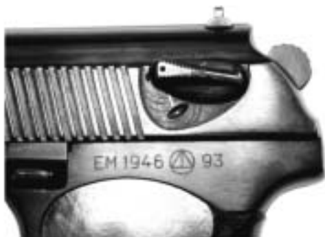
Фото 7. Заводской номер оружия и две последние цифры года его изготовления, нанесённые на рамку пистолета .
