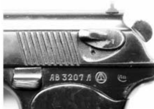
Фото 4. Заводской номер оружия, на рамке пистолета и на флажке предохранителя.
