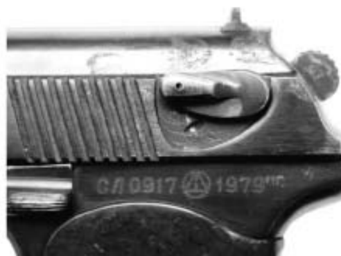
Фото 6. Заводской номер оружия и год его изготовления, нанесённые на рамку пистолета микроударным способом.
