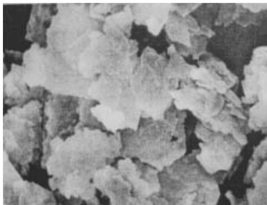
Рис. 1. Алюминиевые частицы в форме "Хлопьев" (увеличение 450 x )
