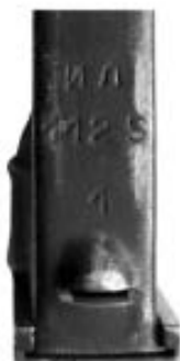
Фото 3. Заводской номер оружия, на корпусе магазина (выполнен давлением).
