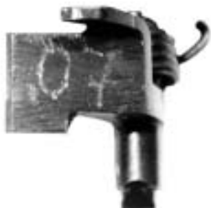
Фото 11. Две последние цифры заводского номера пистолета, нанесённые на поверхность шептала.
