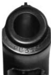
Фото 1. Заводской номер оружия, нанесённый на передний торец затвора.
