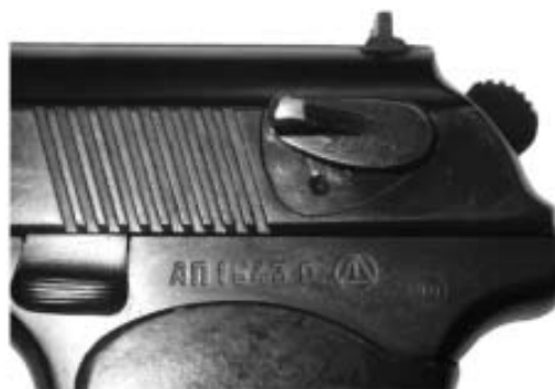
Фото 2. Заводской номер оружия, на рамке пистолета, нанесённый фрезерованием.
