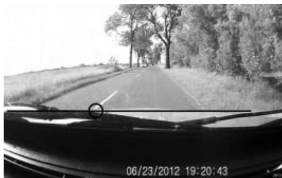
Фото 36. Совмещение в створе линии разметки и переднего среза капота ТС
