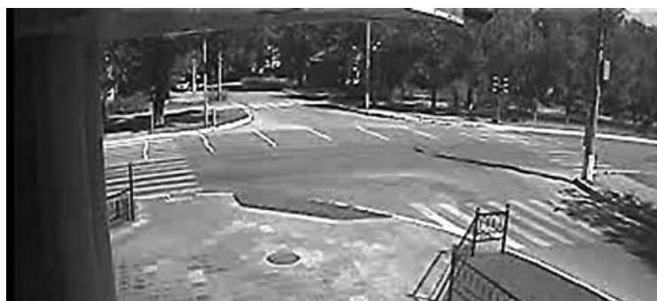
Фото 12. Кадр экспериментальной видеозаписи, фиксирующей шкалу, отметки которой обозначены на местности белыми лентами, уложенными с интервалом 2м. поперёк полосы движения
