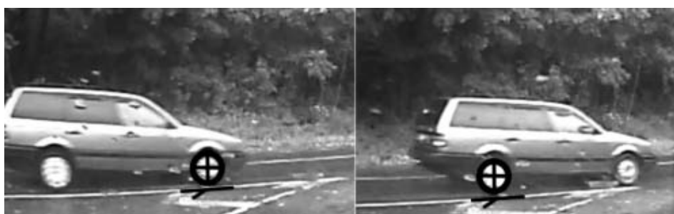
Фото 33, 34. Кадры, снятые движущейся камерой, фиксирующие смещение ТС на величину базы относительно неподвижного ориентира (линий горизонтальной разметки)
