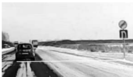
Фото 35. Совмещение в створе ТС и репера, находящегося в стороне от его линии движения
