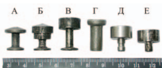
Фото 9. Общий вид стальных сердечников пуль травматических патронов комплексу «Оса»: А – первоначального варианта пули патрона 18х45Т производства ГУП ФНПЦ «НИИ прикладной химии», Б – модернизированного варианта пули патрона 18х45Т производства ГУП ФНПЦ «НИИ прикладной химии», В – пули патрона 18х45Т производства ООО «Новые оружейные технологии», Г - пули патрона 18х45 производства ООО «А+А», Д - пули патрона 18,5х55 производства ООО «А+А», Е – один из вариантов пули патрона 18,5х60Т.
