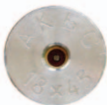
Фото 14. Маркировка гильзы патрона 18x45PШ производства ООО «АКБС».
