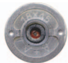
Фото 15. Донная часть гильзы патрона 18x45 производства ООО «А+А» (для контрастности изображения, поверхность обработана черным дактилоскопическим порошком).
