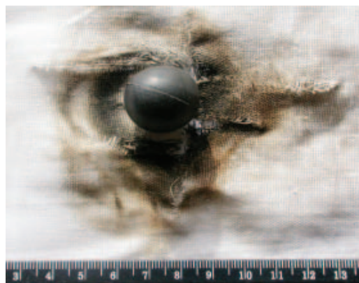
Фото 30. Общий вид повреждения на ткани, образованного выстрелом патроном 18x45РШ с дистанций 0см (упор). Для наглядности помещена пуля, которой образовано данное повреждение.
