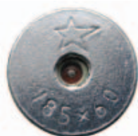
Фото 25. Маркировка на дне гильзы патрона 18,5х60Т.
