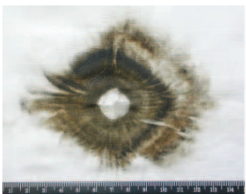
Фото 32. Общий вид повреждения на ткани, образованного выстрелом патроном 18,5х55Т с дистанций 20см. Для наглядности помещена пуля, которой образовано данное повреждение.
