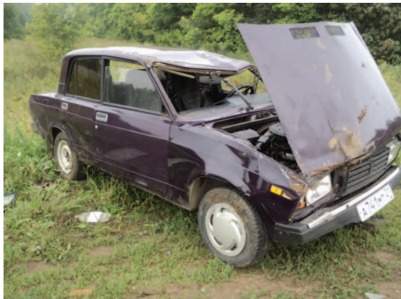
Фото 7. Повреждения панели крыши автомобиля, полученные при опрокидывании.
