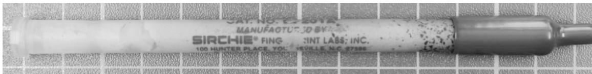
Рис. 6. Йодная трубка для работы на осмотрах мест происшествий производства компании «SIRCHIE» (США)
