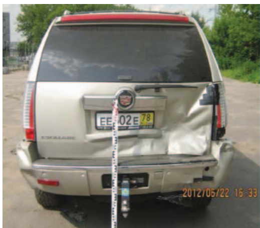
Фото 3,4. Образование парных следов при попутном столкновении.
