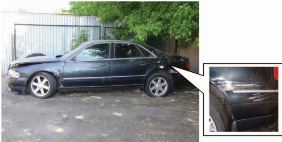
Фото 6. Повреждения, полученные автомобилем при касательном столкновении.
