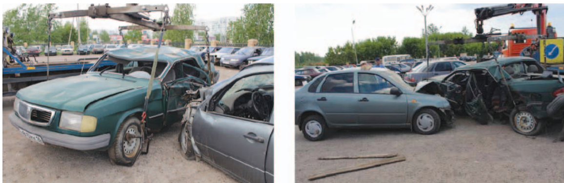
Фото 1,2. Проведение осмотра с использованием специального подъемного устройства.
