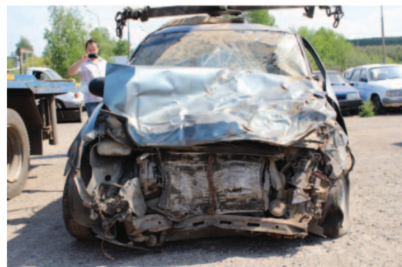
Фото 5. Повреждения автомобиля, полученные при блокирующем столкновении.
