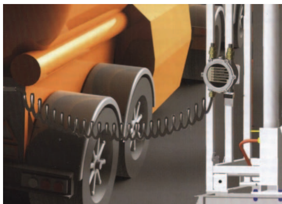
Рис. 3. Заземление автоцистерны конструкции ОАО "ПРОМПРИБОР"[8].
