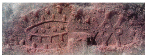
Рис.4. Тот же след, обработанный порошком «SNOW PRINT POWDER»
