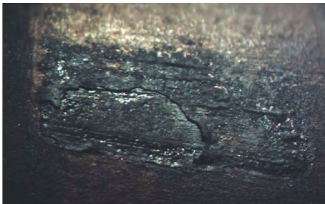
Рис. 7. След поля нареза на выстреленной пуле, обожженной при температуре 1000°С и времени обжига 30 минут.
