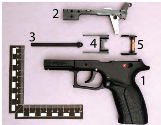
Фото 1. Части и детали пистолета Grand Power T12 калибра 10x28Т:
