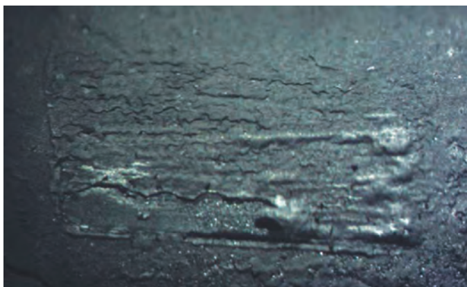
Рис. 7. След поля нареза на выстреленной пуле, обожженной при температуре 1000°С и времени обжига 30 минут.
