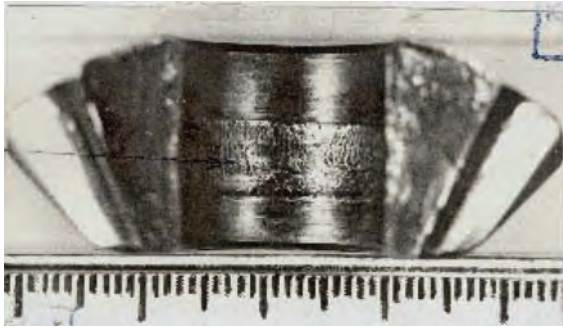
Рис. 3. Следы износа на внутренней поверхности фрагмента сателлита
