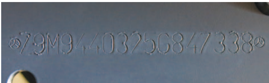
Рис. 10. Идентификационный номер после нанесения на раму дополнительного защитного покрытия.
