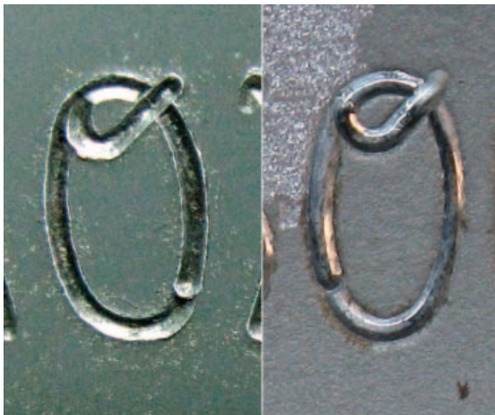
Рис. 3. Цифровое обозначение «0», выполненное в два этапа: 1-й – овалный элемент: снизу, влево, вверх, направо, вниз, 2-й – дуговой элемент
