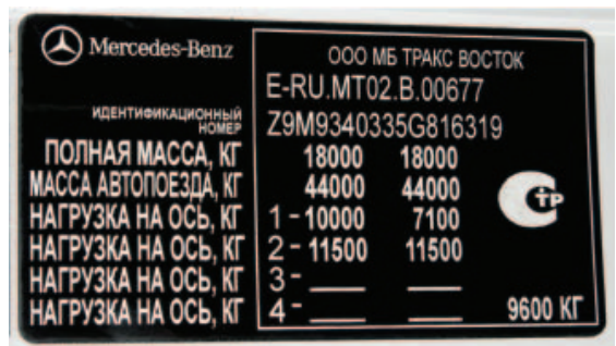
Рис. 13. Маркировочная табличка, выполненная при помощи плоттера.
