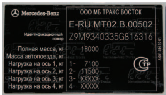
Рис. 12. Маркировочная табличка, выполненная при помощи лазера.
