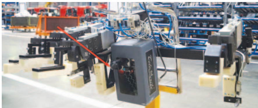
Рис. 7. Автоматизированный маркиратор (стрелкой показана контактная игла).
