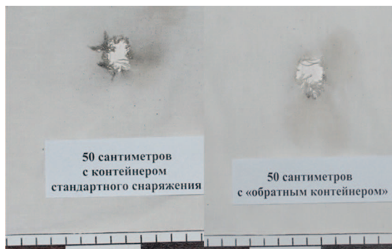
Фото 14. Общий вид повреждений, образованных при стрельбе с дистанции 50 см патронами, стандартно снаряженными дробью в контейнере и патронами, снаряженными дробью с «обратным контейнером».
