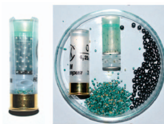
Фото 2. Общий вид патрона на дальние дистанции в разрезе и компонентов его снаряжения.
