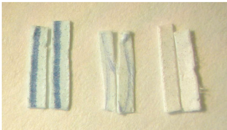
Рис. 1. Вырезки со штрихами рукописных реквизитов, выполненных пастой шариковой ручки, после суточной экстракции в метаноле. Реквизиты исследовались при производстве повторной экспертизы. Слева – вырезки из контрольного штриха; в центре – вырезки из исследуемой подписи; справа – вырезки из чистой бумаги документа.
