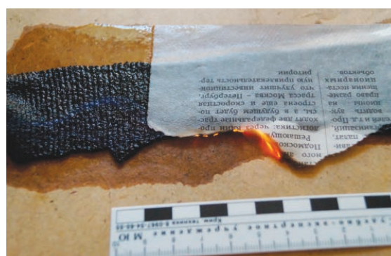
Рис. 1б. Горящие пары спирта над тканью, смоченной водкой и расположенной на прессованном картоне, воспламеняют бумагу, но не саму ткань.
